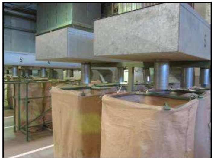
Escogedora neumática. El ruido procede del proceso neumático de selección.
