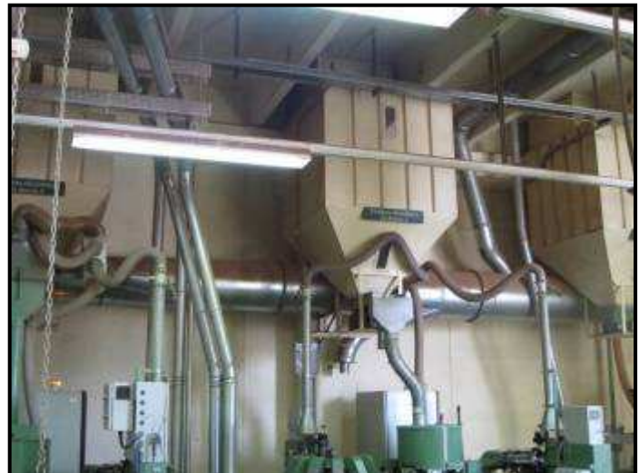
Ejemplo de extracción de polvo para prevenir la suberosis. Ruido por proceso neumático.
