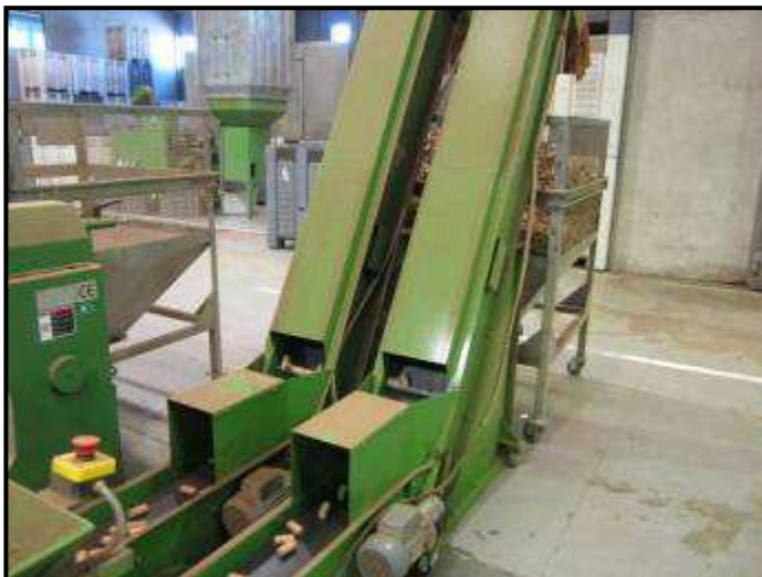
Cinta transportadora de tapones. Sin ruido ya que no es neumática sino mecánica.
