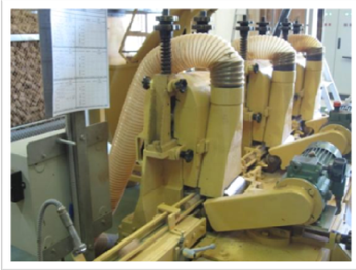
Esmeriladora con sistema de extracción de recogida de polvo
