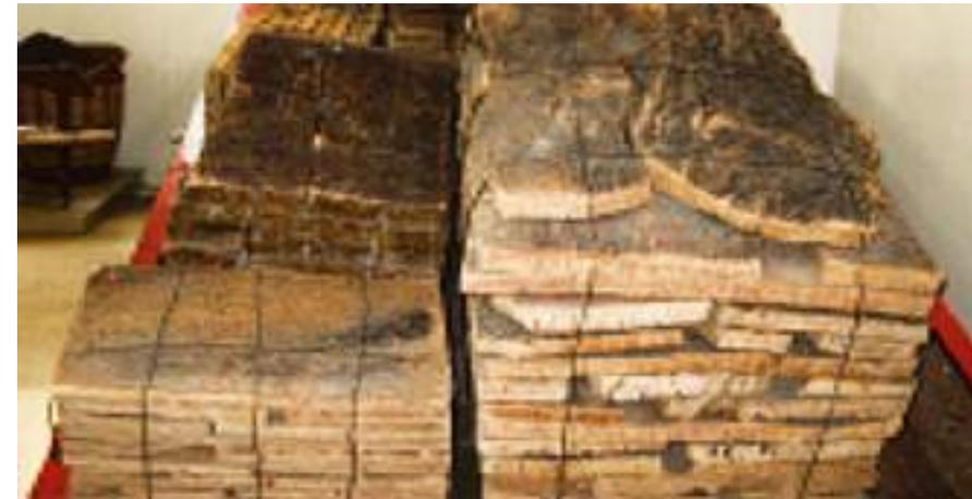
Los fardos tienen unas dimensiones aproximadas de 90x60x60, 100X60X60... y su peso oscila entre 80 y 90 Kg.; además cada fardo está compuesto por planchas de un mismo espesor y calidad similar.
