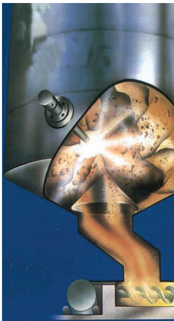
Figura 63. Sistema de eliminación de acumulaciones de material CARDOX.
