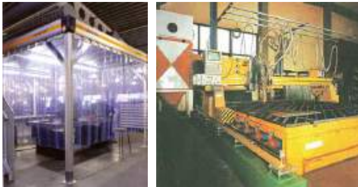
Cabina de soldadura con aspiración
