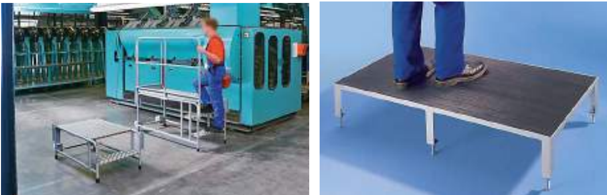
Figura 4.5.15. Plataformas para trabajos a distinta altura.
