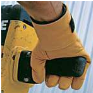
Figura 4.1.21. Guantes y asideros antivibración.
