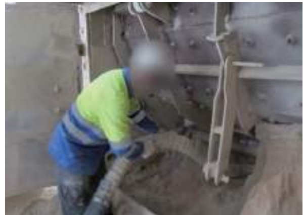
Figura 4.2.5. Aspiración del material situado en el interior de la trituradora.
