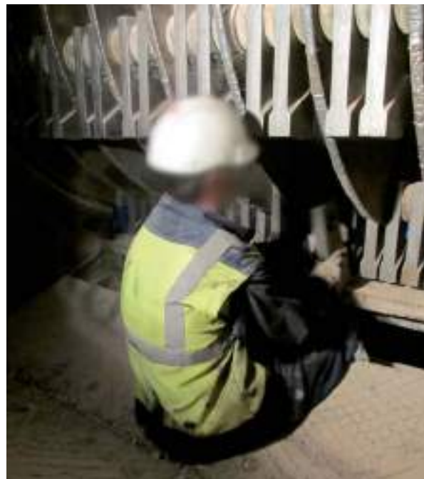
Figura 4.2.3. Sustitución de martillos desgastados en la trituradora.
