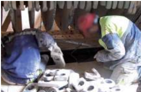
Figura 4.2.22. Retirada de martillos y distanciadores desgastados en la base de la trituradora.
