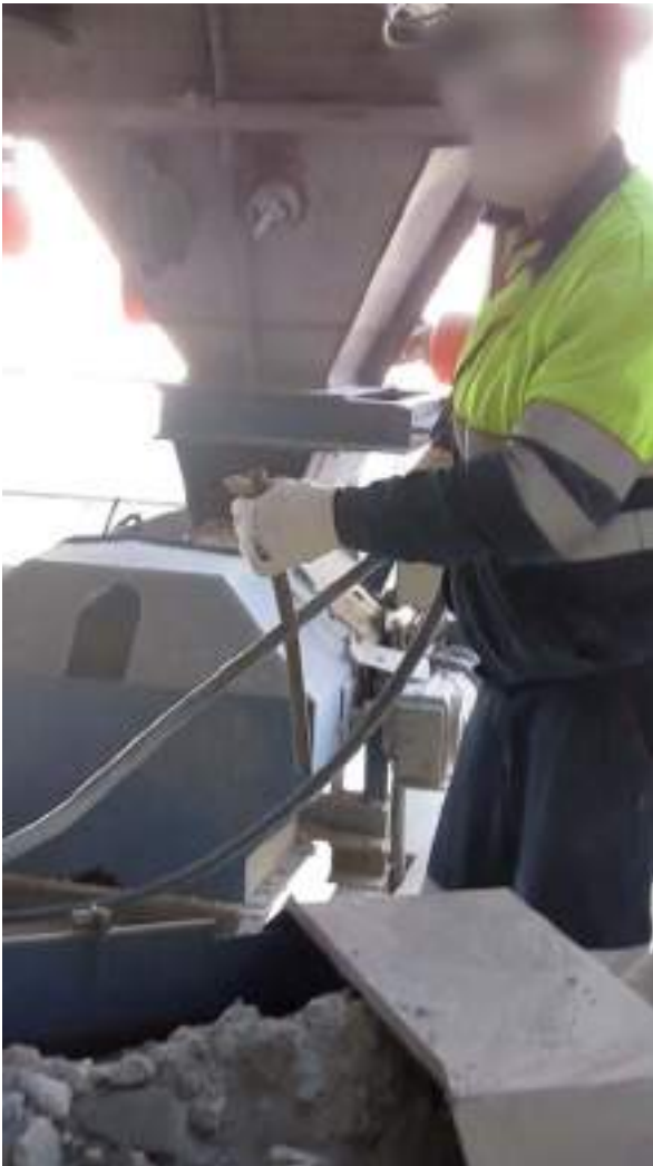
Figura 4.1.5. Desatranque de silos mediante lanza de aire.
