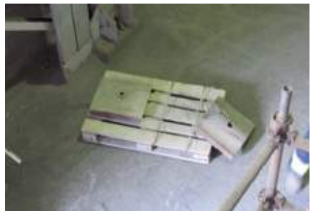
Figura 4.3.2. Distintas tipologías de placas según la cámara del molino donde van a ser instaladas.
