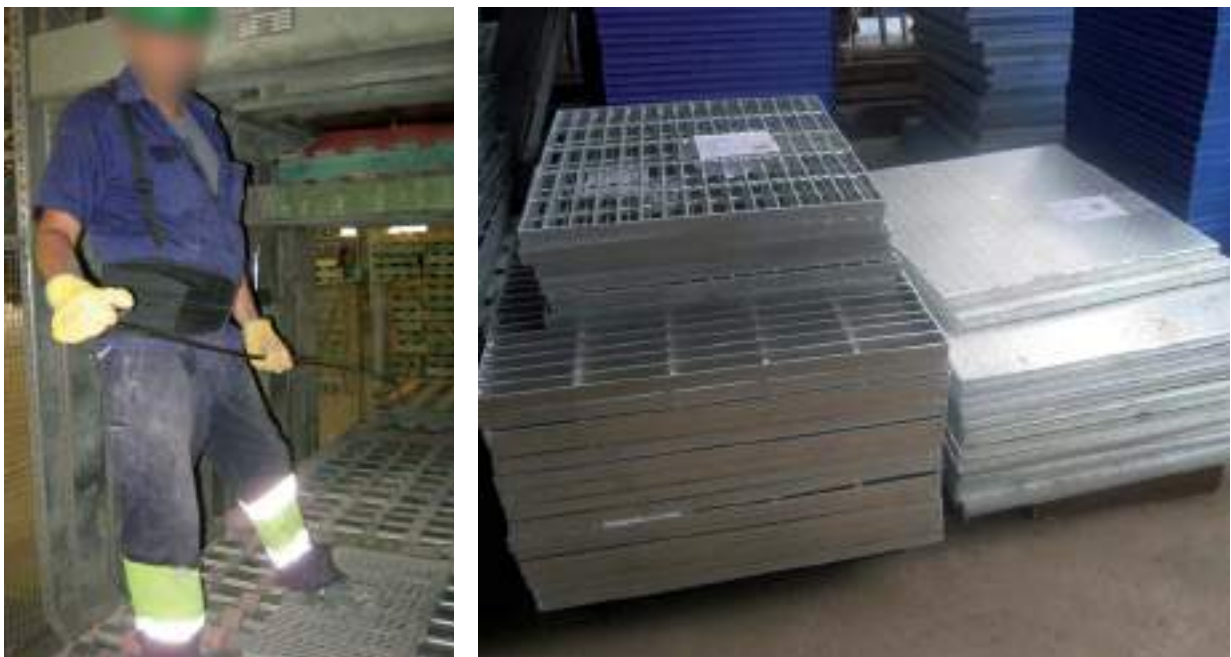
Figura 4.4.23. Superficie de acero colocada encima de los rodillos de los paletizadores para disminuir el riesgo de caída.
