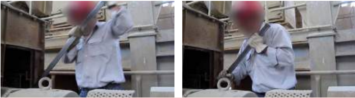
Figura 4.1.12. Golpeo de pegaduras en las tolvas de transferencia entre transportadores mediante el uso de barra.
