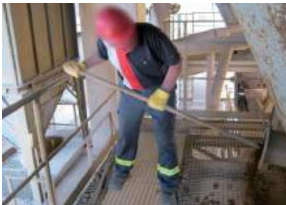
Figura 4.1.2. Tarea de desobstrucción de tolvas.
