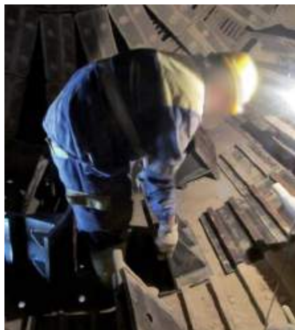
Figura 4.3.17. Manipulación manual de placas en el molino con bolas de molineta extraídas.
