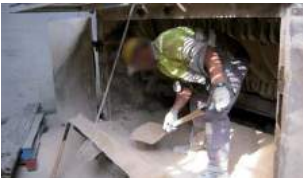
Figura 4.2.12. Posturas forzadas durante las operaciones de retirada de material y liberación de martillos en la trituradora mediante soplete.
