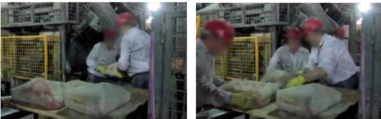
Figura 4.4.14. Manipulación de sacos a la altura de los trabajadores.
