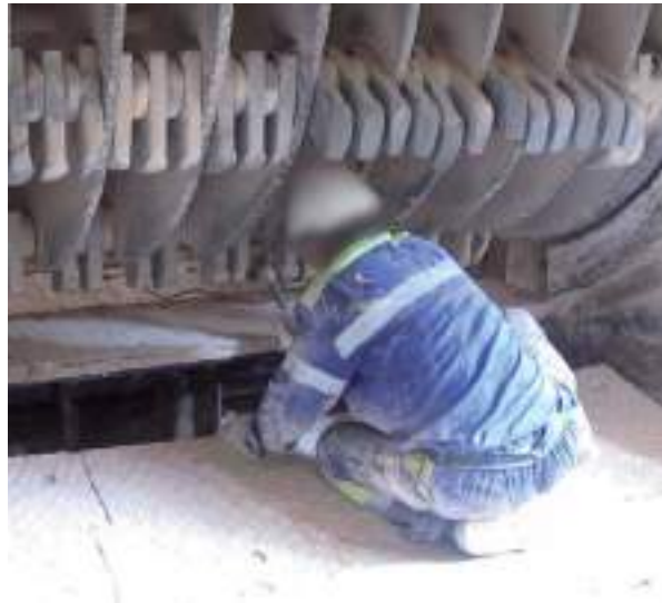
Figura 4.2.26. Golpeo de los martillos de la trituradora para su liberación.
