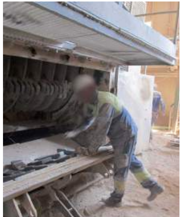
Figura 4.2.25. Acceso al interior de la trituradora.
