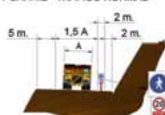
PISTA CON ARCEN PARA PEATONES SIN ARCEN DE SEGURIDAD 1 CARRIL - TRAFICO NORMAL
