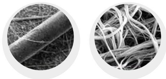
Fibras de amianto
