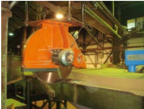
Sierra circular móvil. Corte que determina la longitud del tablero.
