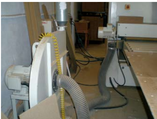
Lijadora de superficies planas. Detalle sistema de aspiración.
