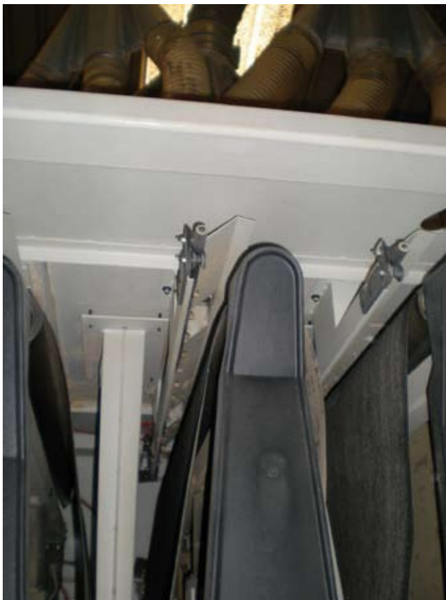
Lijadora de superficies planas. Detalle de las bandas de lijado.
