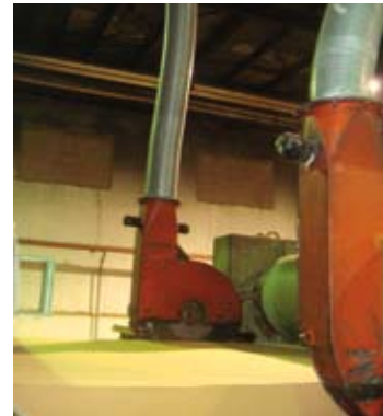
Sierra circular móvil. Corte que determina el ancho del tablero
