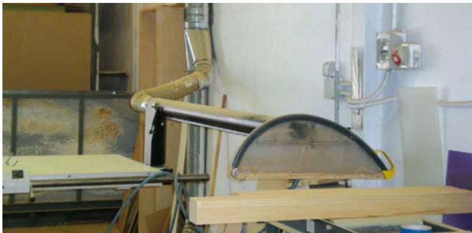
Sierra circular. Detalle dispositivo de captación.
