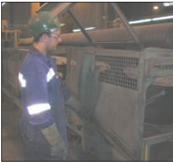
Operario manipulando una trefiladora. EPIS: gafas de seguridad, guantes contra riesgos mecánicos, mono reflectante, casco
