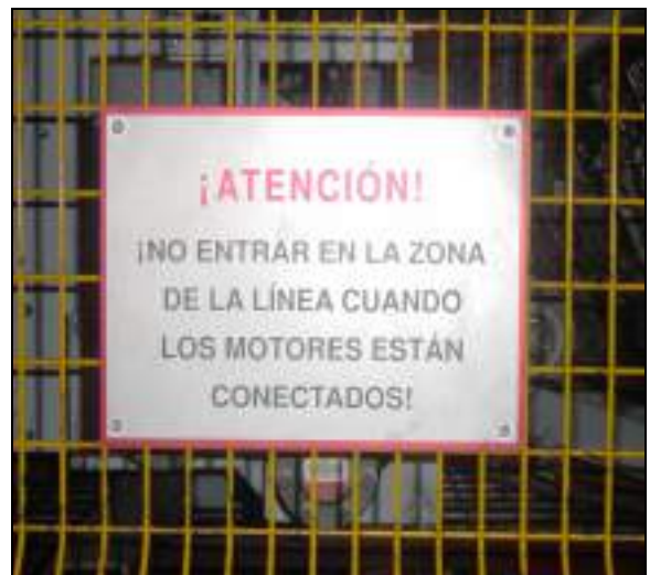
Protecciones para impedir que las personas puedan circular por las zonas en que se puedan producir peligros.
