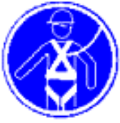
Protección Individual Obligatoria contra caídas
