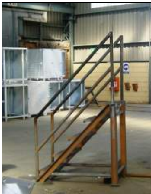
Escalera para carga camiones
