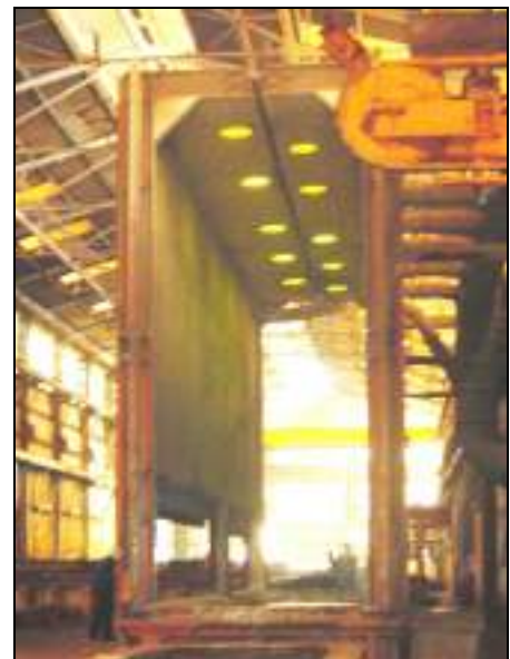
Pantallas de protección de una cuba de galvanizado
