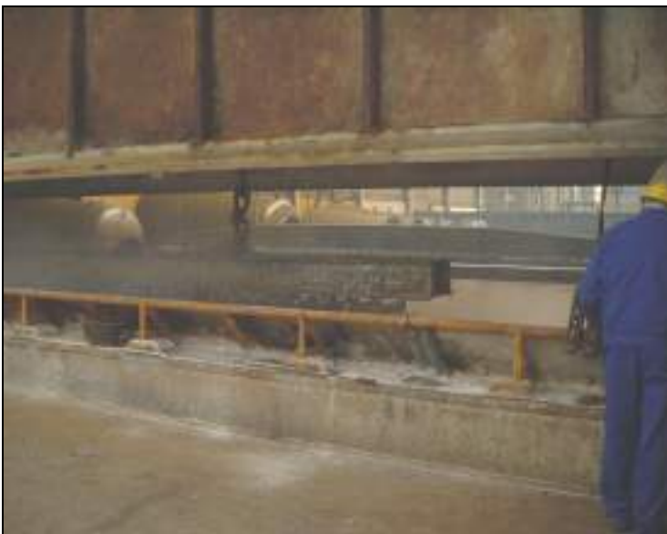
Pantallas de protección de una cuba de galvanizado
