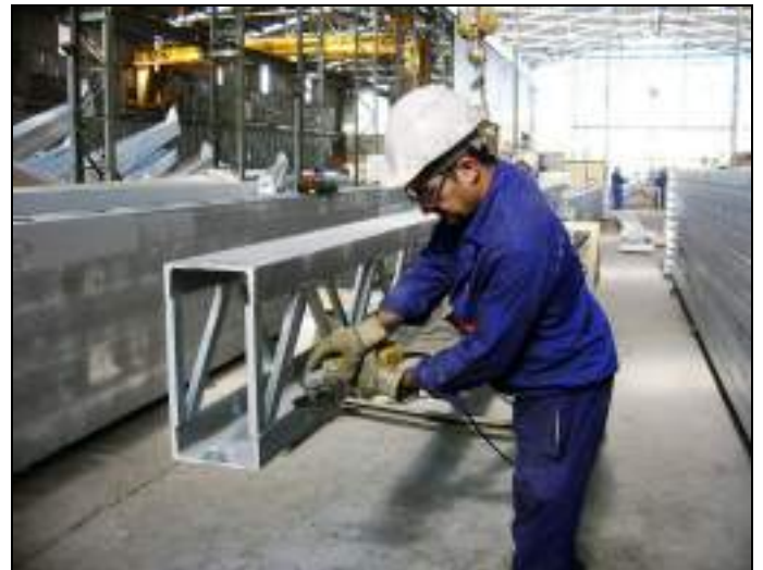
Operario realizando el repasado con lijadora eléctrica. Equipos de protección individual: calzado de seguridad, guantes contra riesgos mecánicos, casco, gafas.
