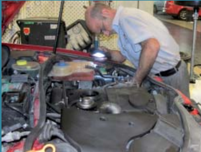
Figura 79 – Iluminación portátil de apoyo.
