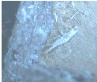
Fig 1: Presunto MCA (Fibras visibles en la superficie).
