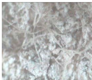
Fig 3: Presunto MCA (Fibras visibles en la superficie de un panel aislante. No se observa la formación en haces típica de las fibras de amianto)
