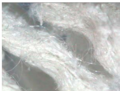
Fig 4: Presunto MCA (masa fibrosa con mezclas de distintos tipos de fibras)
