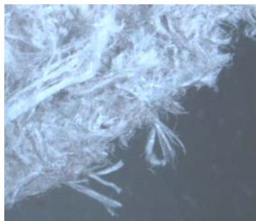
Fig 2: Presunto MCA (Fibras de amianto visibles en el borde de una fractura. Los extremos de las fibras abiertos indican su formación en haces, típica de las fibras de amianto).
