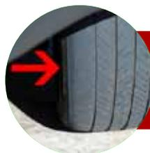
En un neumático sin dibujo, la presión del agua a 70 km/h es de 2 bar. A más velocidad o menor inflado de las ruedas (menos de 2 bar), se produciría el "aquaplaning".
