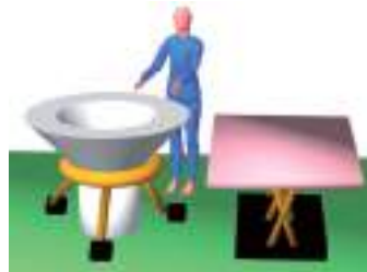
Figura 91 – Soporte elevado con ruedas para evitar el vaciado a ras de suelo
