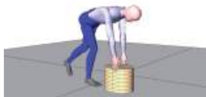
Figura 100 – Superficie de apoyo para evitar trabajar a ras de suelo
