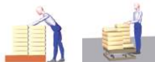
Figura 60 – Para evitar los alcances alejados en los palets, una solución puede ser colocar el palet en plataformas giratorias.
