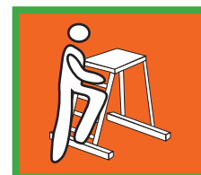
Asegurar el estado de las escaleras No subir con cargas que impidan sujeción y reduzca la visibilidad
