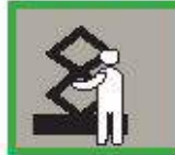
Riesgo de atrapamiento de extremidad superior en estructura extensible
