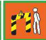
Señalizar con bandas alternas. En máquinas o zonas de riesgo
