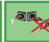
Para desconectar: coger de la clavija y no del cable. Revisar enchufes, cuadros eléctricos y cableado
