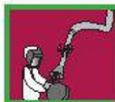
Trabajos de soldadura siempre con sistema de extracción localizada
